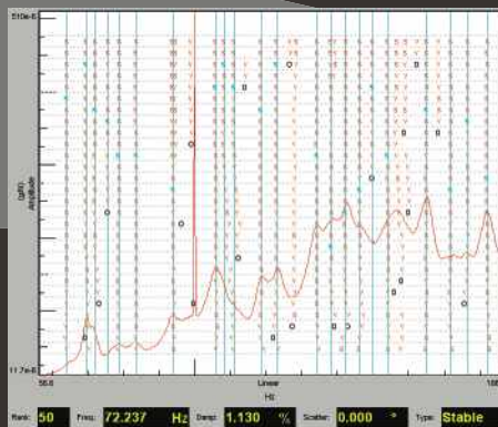
Diagram stabilizacyjny służący do wyznaczania częstotliwości drgań własnych układu
